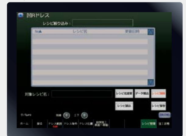
レシピ機能 加工やドレス条件を保存・読みしします。 Recipe Grinding data and dressing data can be saved screen.
