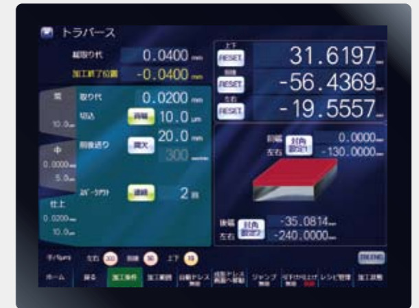
レシピ機能 加工やドレス条件を保存・読みしします。 Recipe Grinding data and dressing data can be saved screen.
