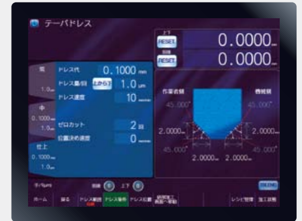
加工条件設定 Grinding condition setting
